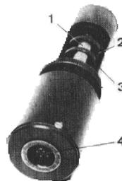
Bild 12 Beta-Gammasonde
