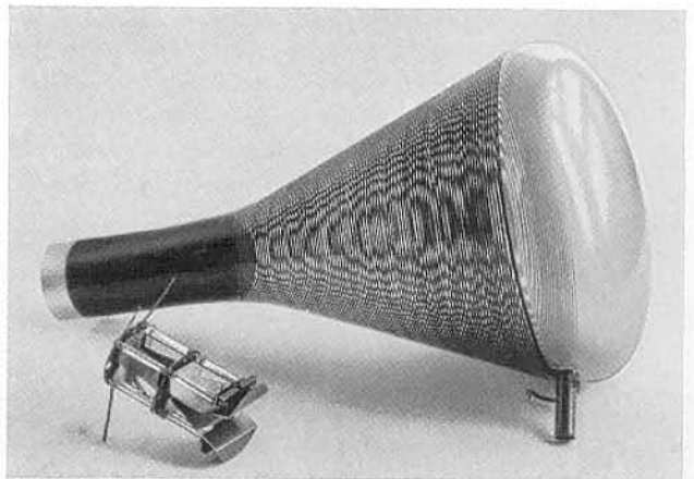
Abb. 3: Röhre mit spiralförmigem Nachbeschleunigungswiderstand.
