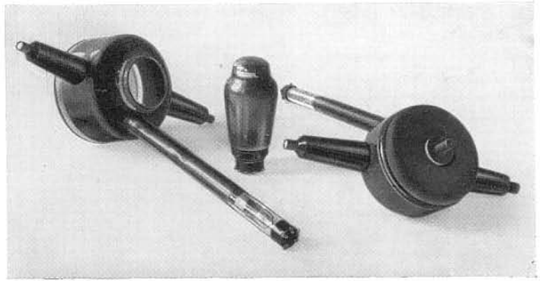
Abb. 6: Kleinprojektionsröhre für Heimprojektionsempfänger (in Vorder- und Rückansicht)
